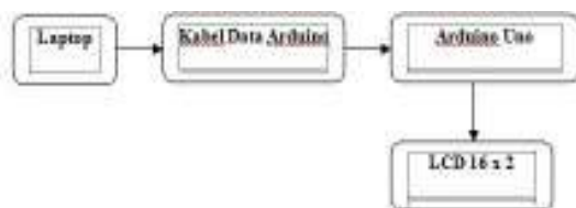
Gambar 8. Blok Diagram Pengujian Rangkaian LCD dengan Arduino Uno
