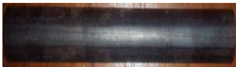
Gambar 4. Poros /As terhubung dengan mata pisau
